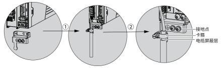
Figure 1-16 屏蔽支架安装示意图
